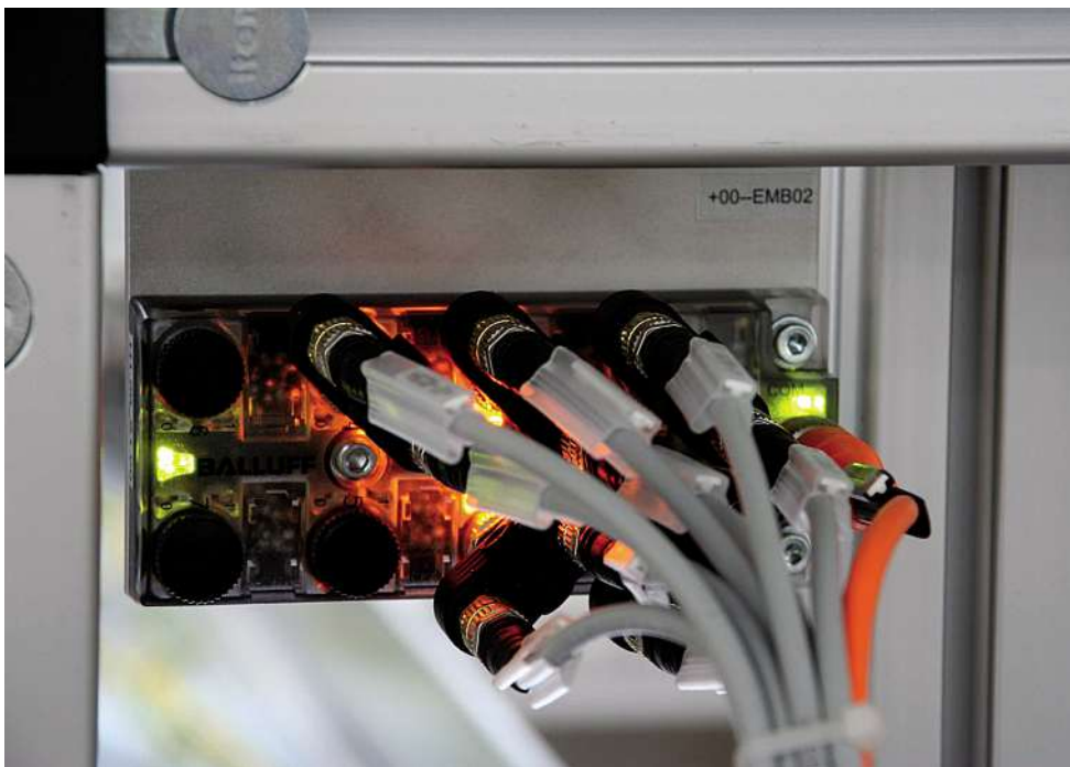
Bild 1: Die Balluff-Sensorhubs sammeln die Signale der schaltenden Sensoren ein und bündeln dabei je nach Variante acht oder 16 Eingänge auf einen IO-Link-Anschluss.
